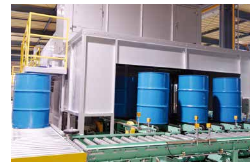
業界初の山型炉を導入した塗装焼き付け乾燥炉
