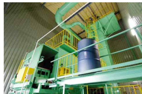
外部研掃(ショットブラスト) ショット効率を高めた装置でドラム表面を滑らかに。塗装後の仕上がり品質がUP
