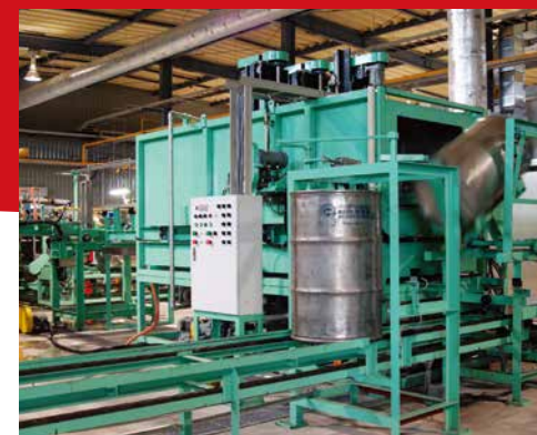
外部洗浄装置
